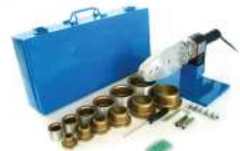
D20-63 (1/2"-2") (แผ่นความร้อนขนาดกลาง พร้อมหัวเชื่อมขนาด 20, 25, 32, 40, 50, 63 mm) (Medium heating plate)
